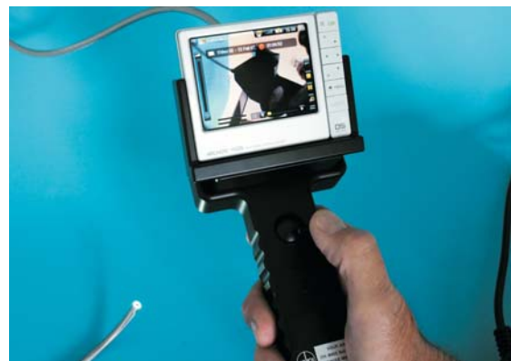
Video Endoscope with Chip on the Tip Videoendoskop mit Chip-on-the-Tip
